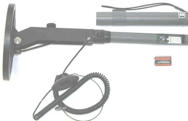
Bild 5 Batteriefach im Elektronikzylinder und 9V Alkaline Batterie (6LR61 )
